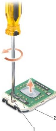
1 ZIF 插槽 Cam 螺絲 2 ZIF 插槽
